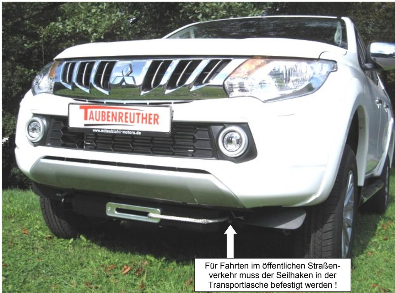
**Hier sehen sie den fertig montierten Seilwindenanbausatz.**
